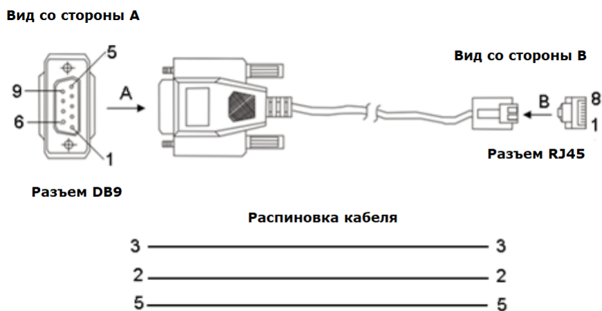
Рисунок 26 Распиновка консольного кабеля DB9-RJ45
