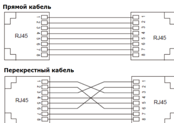
Рисунок 19 Подключение с помощью прямого/перекрестного кабеля
