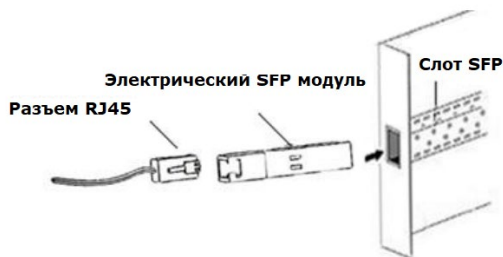
Рисунок 24 Подключение медного модуля SFP
