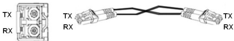
Рисунок 21 Подключение оптического модуля SFP к оптическому кабелю
